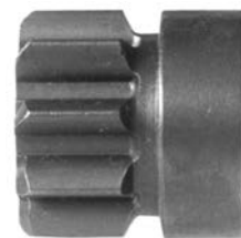
134177 # Dp Gear ID 14.00, OD 34.30, Height 42.60, No./ teeth 9
