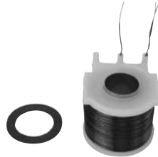
138940 Solenoid Coil 24 V, ID 21.10, OD 46.75
