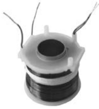
138929 Solenoid Coil 12 V, ID 20.85, OD 46.10
