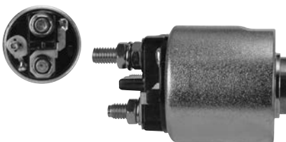
237444 Solenoid Replacing: 594444 Servicing: d6ra91 12 V, B+ M8, Kl. 50 M6, OD 53.90, Total length 89.25, Height/ B+ 30.00, Width/ kl. 50 13.00, Coil bolt M8, Coil bolt 2 22.45, No./ terminals 3
